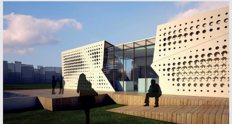
Le mashrabiye sono un sistema di raffreddamento passivo tipico delle zone del Nordafrica e del mondo arabo. Originariamente erano dette così, gli spazi sporgenti dall'abitazione dotati di aperture con particolari grate lignee in grado di garantire il benessere termico igrometrico interno sfruttando le caratteristiche fisiche del legno e climatiche del luogo.
